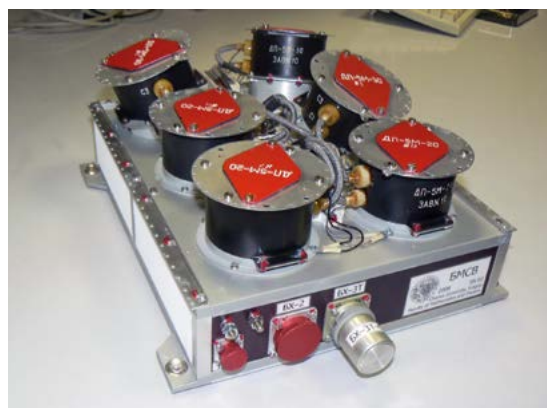
Obr. 1 Foto přístroje BMSW se šesti Faradayovými válci vyvinutého na KFPP MFF UK pro projekt Spektr-R.
