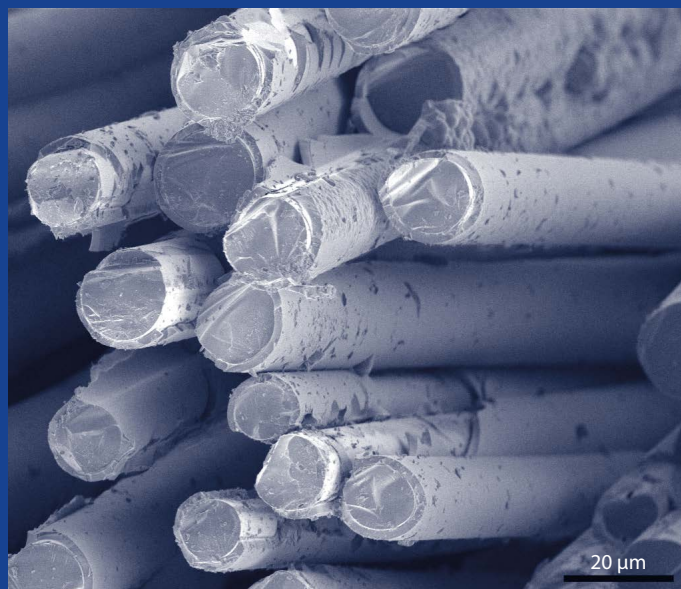
Obr. 2 SiC kompozit – krehká karbidová matrica spevnená SiC vláknami.
